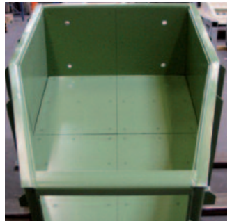
Schleißauskleidung aus Manganstahl
