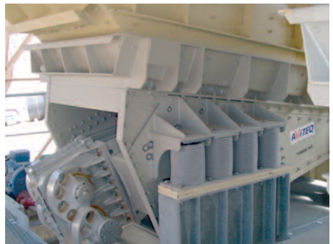
Druckfederabstützung mit Eingriffschutz
